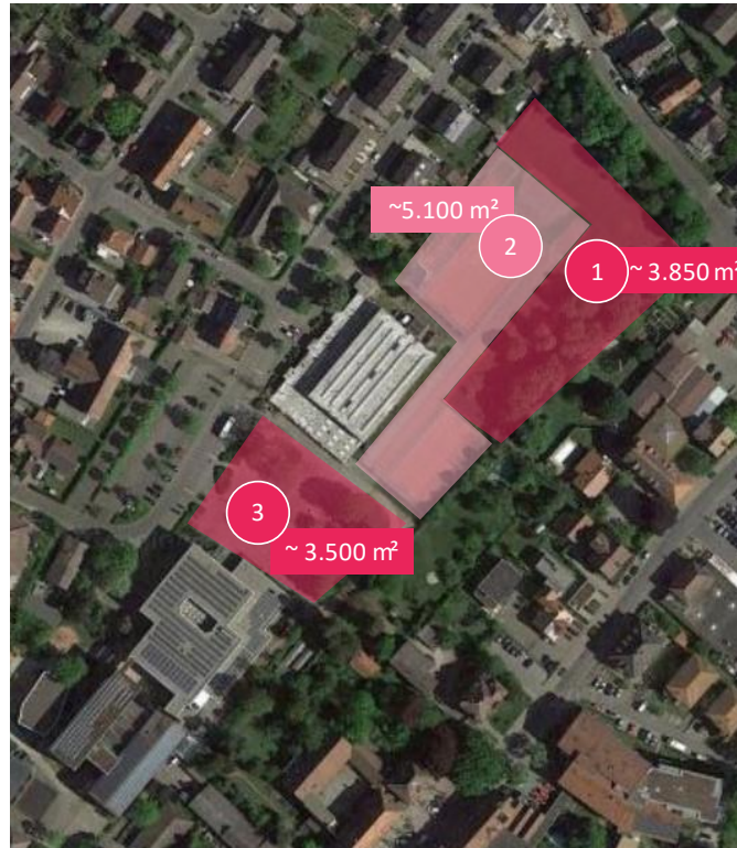
Abbildung 81: Potentielle Flächen für Erdsonden / Grundwasserbrunnen
